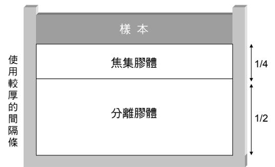
圖 2.1 製備式電泳膠片的鑄膠
