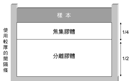
圖 2.1 製備式電泳膠片的鑄膠
