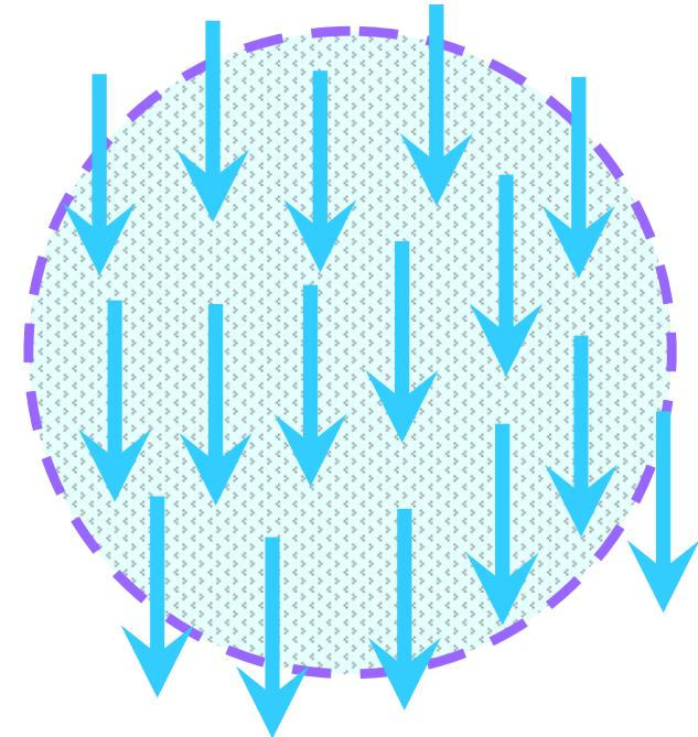
若膠體粒子太大，則由外圍擴散到內部的距離長，通過粒子所需要的時間拉長，降低分離效果。
